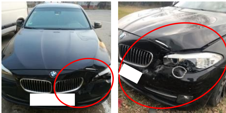
Сл. 9 и 10: Пријављено оштећено ПМВ BMW 530 у осигуравајућој компанији са зоном оштећења.-
