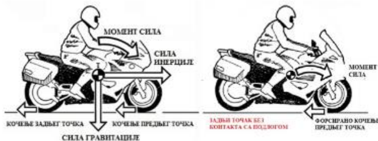
Слика 2. Приказ случаја подизања задњег точка [8]
