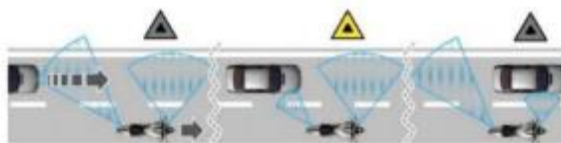
Слика 3. Приказ система за праћења саобраћајне ситуације и упозорења возача [12]
